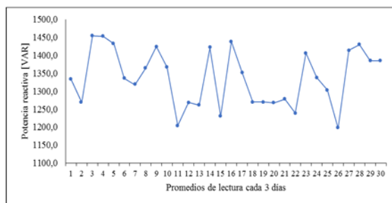
Figura 4. Gráfica de potencia reactiva (VAR/DÍA) en el proceso de cortado de madera
