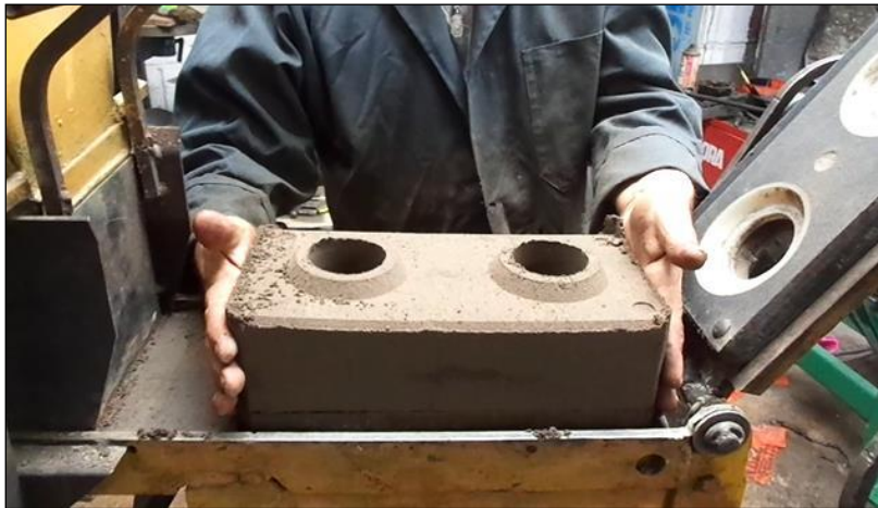
Figura 2. Fabricación de los ladrillos en la máquina prensadora electrohidráulica
