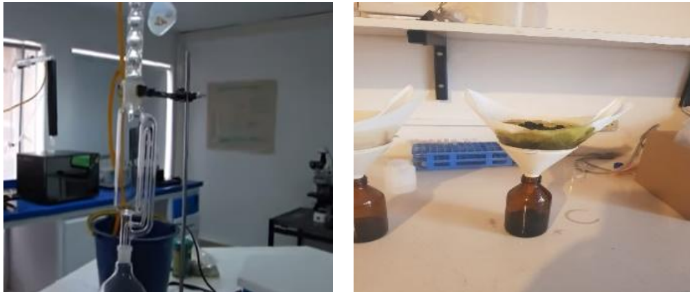
Figura 4. Proceso de extracción del extracto vegetal con solvente orgánico.
